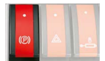
Con el interruptor de vuelco se puede activar manualmente el freno de estacionamiento.
