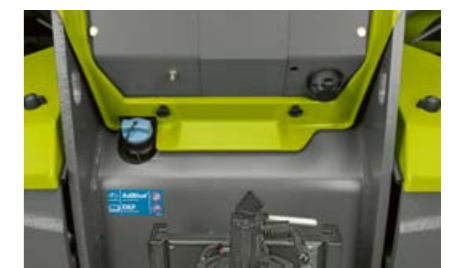
Boquilla de relleno de AdBlue® muy accesible para un tratamiento eficiente de los gases de escape.
