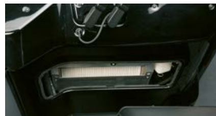
Buen acceso al filtro de aire fresco para la cabina.
