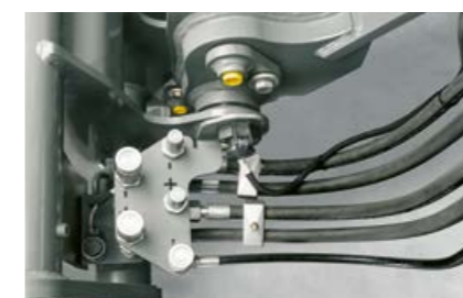
Conexiones hidráulicas colocadas protegidas en el portaherramientas.
