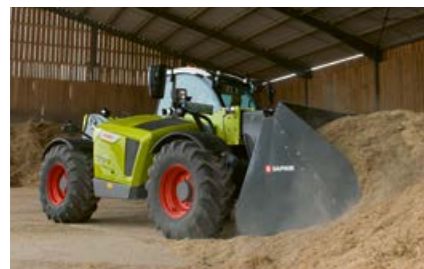
Recogida automática del cazo para trabajar más rápido cerca del suelo.
